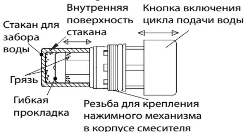
несколько раз нажать на кнопку, чтобы привести механизм в рабочее состояние.
