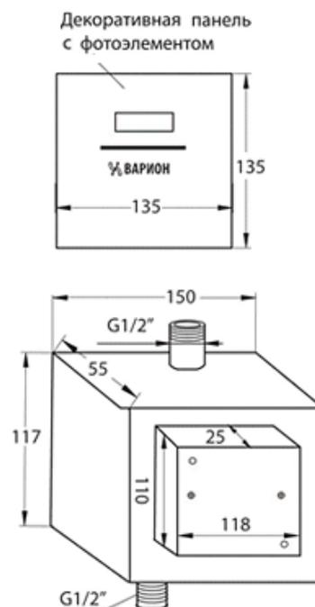
Кран предназначен для скрытого монтажа.
